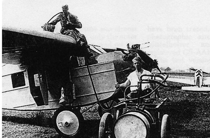
*Le M-18c WkN 447, résulte de l'assemblage d'une aile de M-18b avec un fuselage plus gros et un moteur plus puissant*
