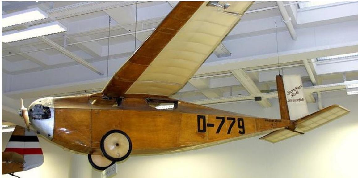
Le Messerschmitt M-17 restauré est exposé au musée des sciences et techniques de Munich. On note que les gouvernes de profondeur et direction sont pendulaires. Pour gagner du poids les surfaces en contre-plaqué sont vernies et les surfaces entoilées en coton sont simplement imprégnées d'enduit de tension.
