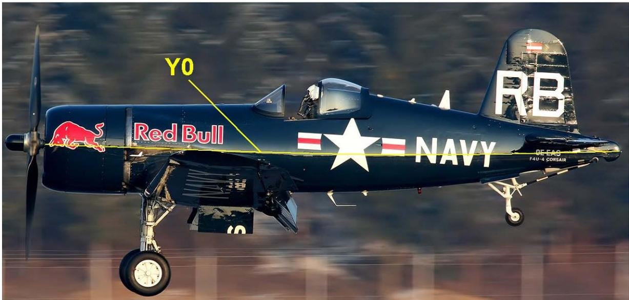
*Evaluation du tracé de la courbe Y0 sur un F4U Corsair à partir du reflet de la lumière sur la peinture du fuselage*
