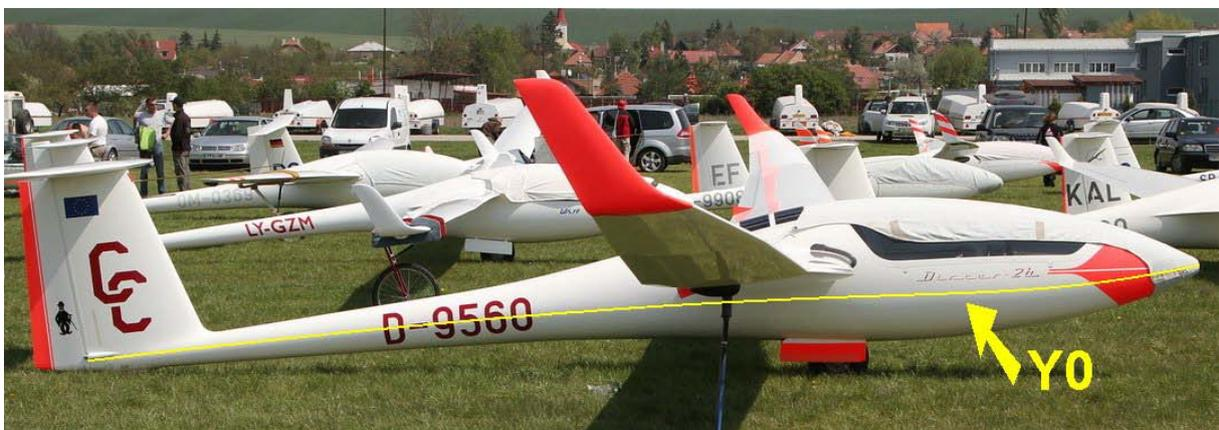
*Sur cette photo la limite entre la partie ombrée et éclairée montre la double courbure de la ligne Y0*
