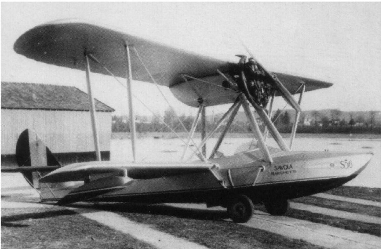
[Le même prototype après avoir reçu un train d'atterrissage relevable manuellement. On note sur les flancs du fuselage l'inscription « Savoia-Marchetti », marsue de commercialisation des avions construits par S.I.A.I.](#)
