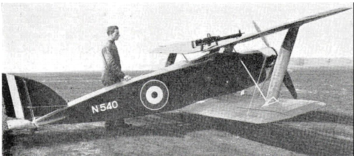
Cette coupure de presse de l'époque permet de se faire une idée précise des dimensions du chasseur de poche qu'était le P.V.8. L'unique mitrailleuse Lewis de 7,7 mm est montée sur le plan supérieur.
