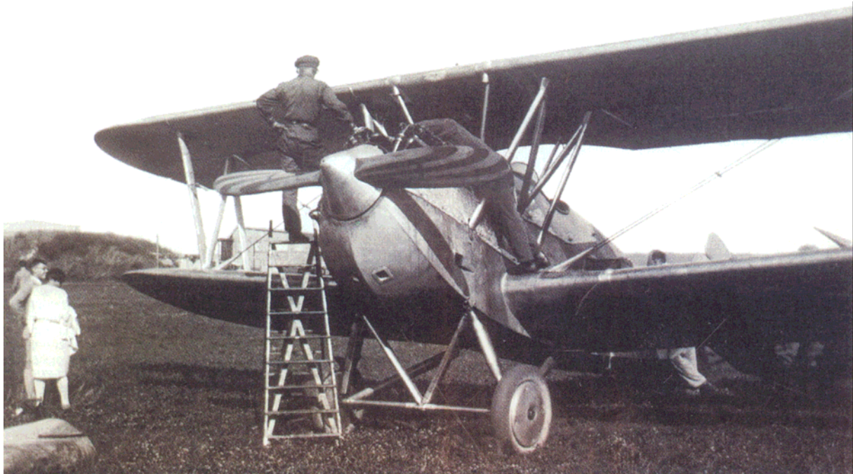
Les mécaniciens s'affèrent sur le moteur BMW VIa d'un des deux prototypes Heinkel HD 23 durant une manifestation aérienne à Warnemünde début février 1927 (Photo Kameradschaft der Marineflieger)
