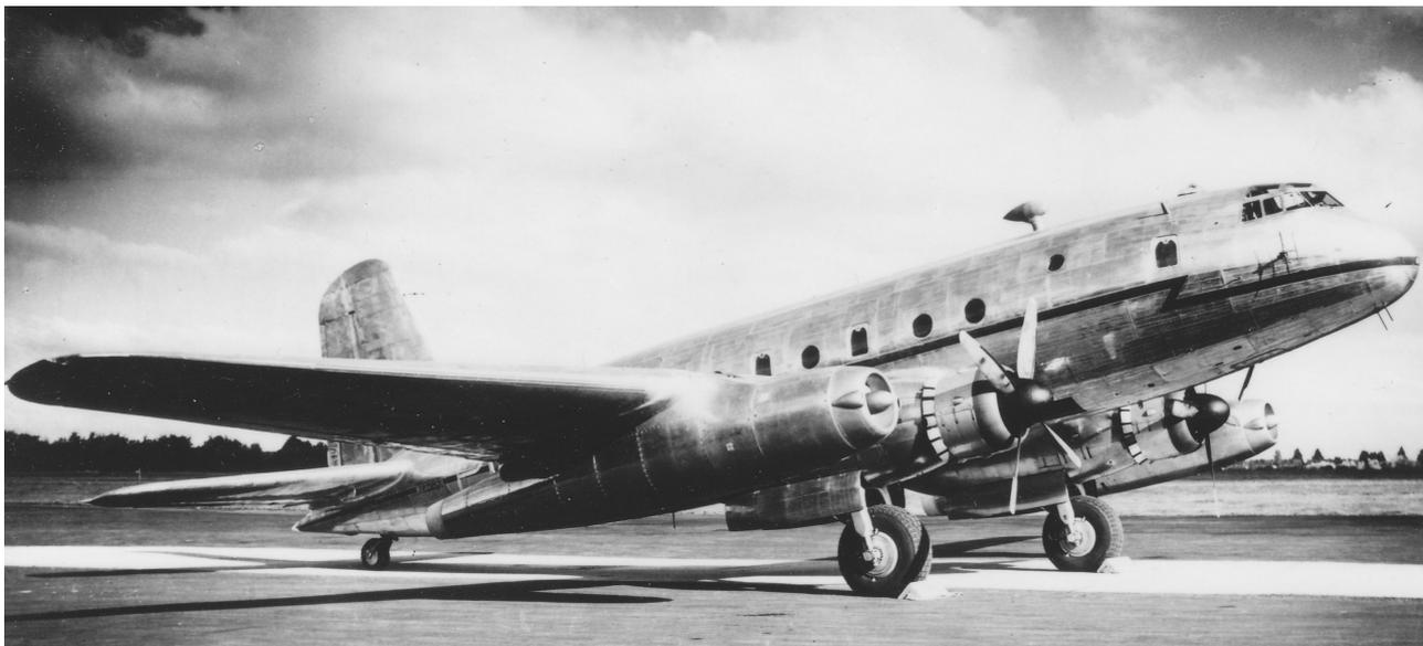
Après avoir achevé les essais de remorquage de planeurs d'assaut Hamilcar, prévus au cahier des charges du Hastings, le second prototype, serial TE583, fut transformé en banc d'essais des réacteurs Sapphire.
