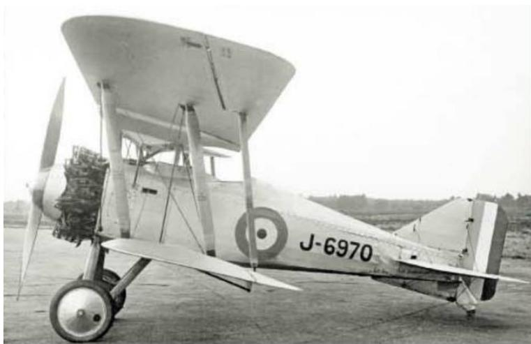
Le monoplace reposait sur un train principal composé de tubes d'acier en V amortis par blocs de caoutchouc et supportant un axe droit pour le train principal. La béquille arrière était amortie par blocs de caoutchouc et débrayable.
