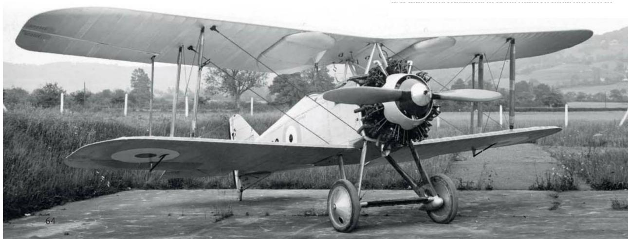
On voit nettement sur cette photo d'usine du J6969, premier prototype du Grebe, le positionnement des réservoirs de carburant, plaqués sous le plan supérieur dont le profil était aminci au centre. Leur forme évoluera légèrement en série.
