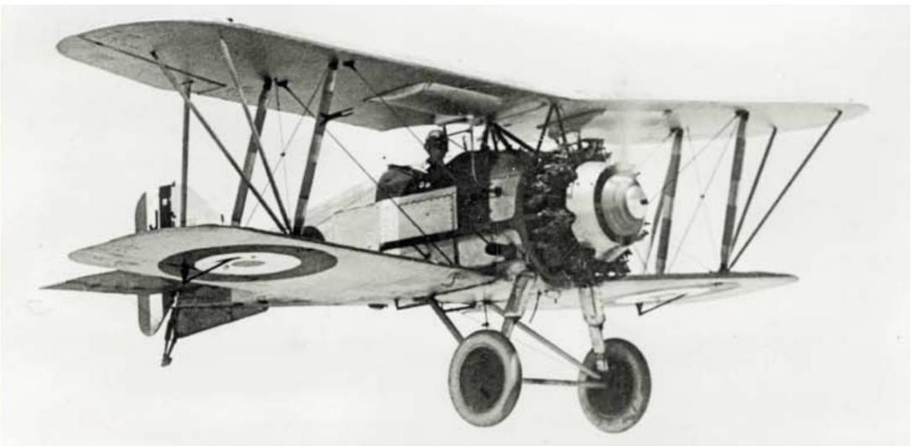
Pour compenser les risques de flutter les Grebe furent temporairement dotés de deux mats obliques supplémentaires en bout d'aile. La solution fut finalement trouvée en modifiant le profil à l'extérieur des mats de voilure.
