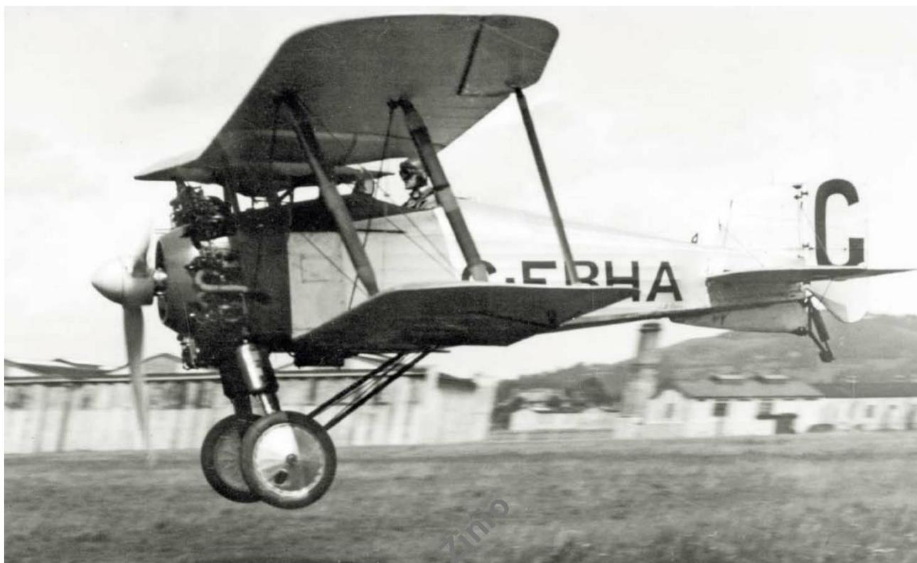
Doté d'un moteur Bristol Jupiter VI de 455 ch et d'amortisseurs oléo-pneumatiques, la quatrième cellule du Grebe fut conservée par Gloster et immatriculée G-EBHA. Utilisé pour des essais et comme avion de démonstration, on le voit ici équipé d'une hélice à pas variable Hele-Shaw/Beacham.
