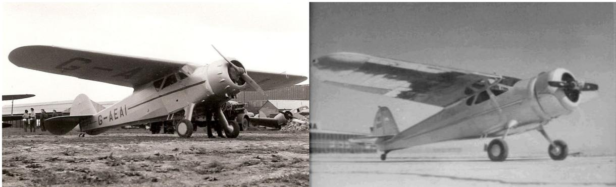
Ces deux photos montrent nettement la filiation entre le Cessna C-34 Airmaster et le P-780. A gauche un C-34 importé en Grande Bretagne en 1936 et perdu sur accident en septembre 1950. A droite, posant devant l'usine Cessna en 1944, le NX4681. Moteur, capot et hélice proviennent d'un bimoteur UC-78. On remarque la taille particulièrement réduite du vitrage de cabine (Photo Cessna).
