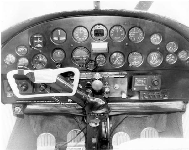
La planche de bord du Cessna 190 était très complète, les commandes de vol pouvant basculer à droite ou à gauche. Une commande en « Y » était proposée en option. L'accès au moteur est facilité par le déverrouillage des deux fixations droite, ce qui permet de faire pivoter le bloc-moteur et d'accéder facilement aux accessoires.
