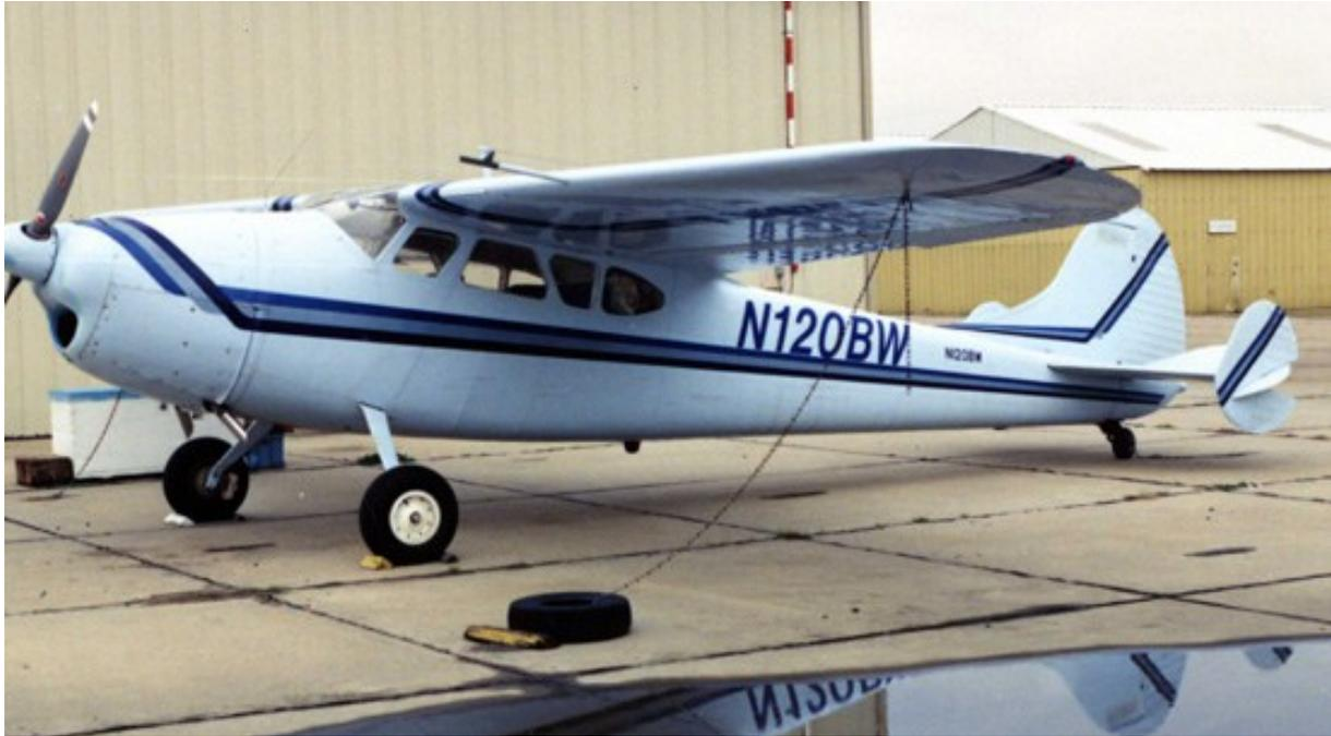
Ce Cessna 195 (cn 7386) a été remotorisé en Californie en 1992 avec un Continental IO-470, moteur 6 cylindres à plat qui en modifie sensiblement l'allure. On note également les surfaces additionnelles d'empennages, recommandées en cas d'utilisation de flotteurs. (Via Cessna 195.org)
