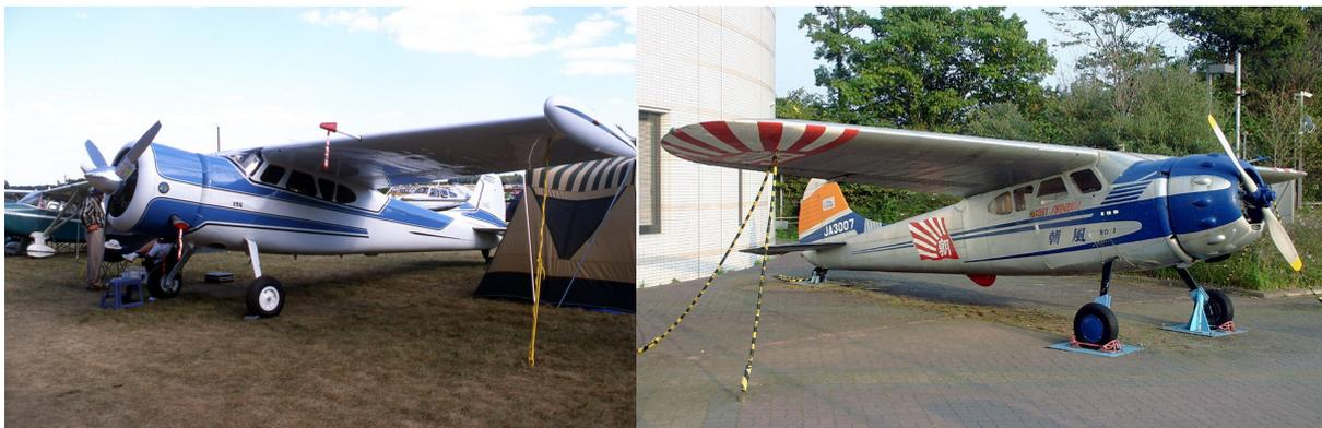
Le montage d'un moteur Pratt & Whitney R-985 entraîne une réduction importante de distance franchissable, compensée sur ce 'Cessna 196' vu à Oshkosh en 1998 (N4383V, c/n 7305) par le
