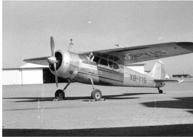
A gauche le capot-moteur caractéristique du Cessna 195. On comprend facilement que les temps de roulage au sol très longs soient déconseillés. A droite un Cessna 196 immatriculé au Mexique. Cette désignation non officielle recouvre des appareils ayant reçu un moteur Pratt & Whitney R-985 Wasp Junior de 450 ch, plus puissant mais aussi beaucoup plus gourmand.
