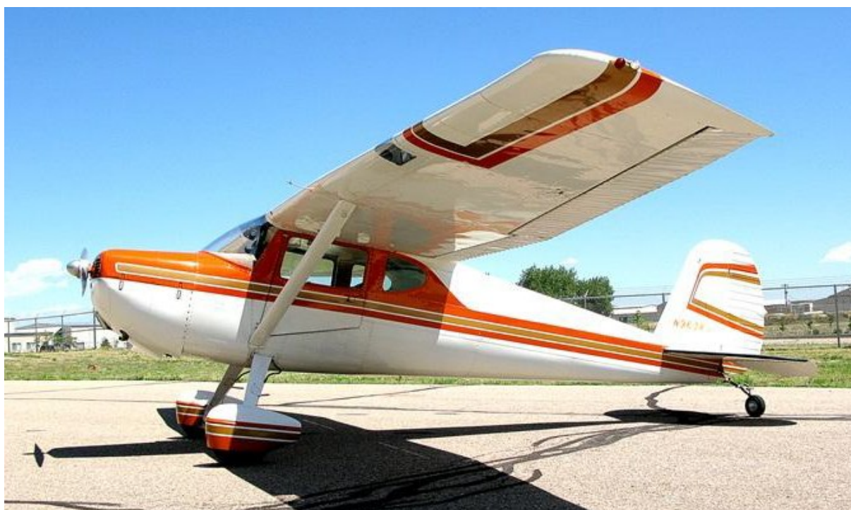
Le Cessna 140A, ici le N9694A, c/n 15415, préfigurait les appareils que l'on connaît aujourd'hui, avec une aile entièrement métallique, de forme caractéristique, contreventée par un mât unique.
