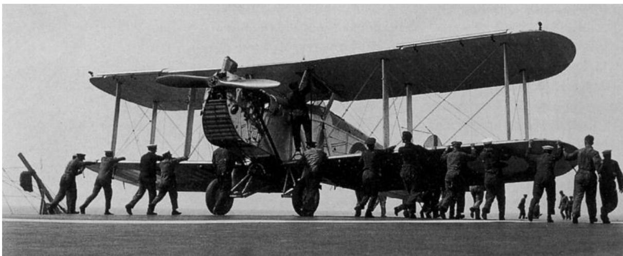
Les marins du HMS Courageous déplaçant un Dart Mk II du No 463 Flight en 1932. On voit nettement sur cette photo les fentes Handley Page de bord d'attaque, montées rétroactivement à partir de 1928. Les crochets d'appontage ont depuis longtemps disparu du train d'atterrissage. (RAF Museum)
