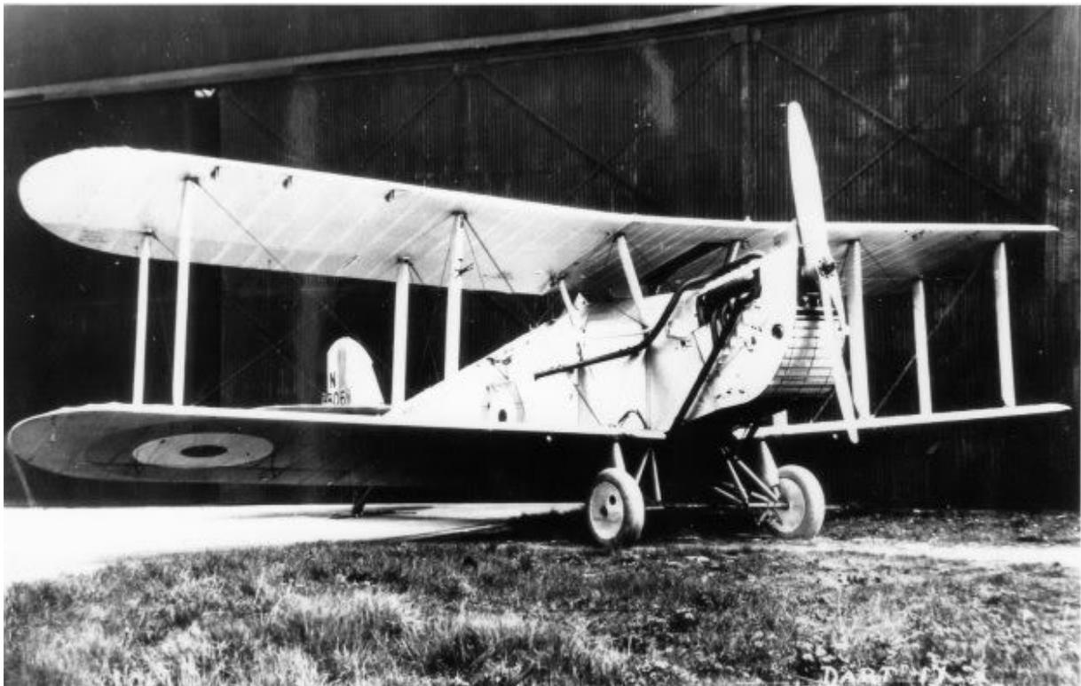
Le Dart N9806 fait partie d'un lot de 32 appareils commandés en août 1924. On aperçoit sous les axes déportés des roues les crochets d'appontage destinés à éviter à l'appareil de faire une embardée. Ce dispositif peu efficace fut abandonné au profit de filets entourant le pont des porte-avions britanniques.
