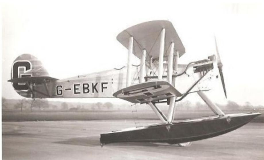
Le G-EBKF de North Sea Aerial & General Transport fut détruit sur accident à Digby le 7 janvier 1932. Les roues, relevables entre les flotteurs, comme les béquilles situées à l'arrière des flotteurs, avaient une utilisation limitée aux mouvements de mise à l'eau.
