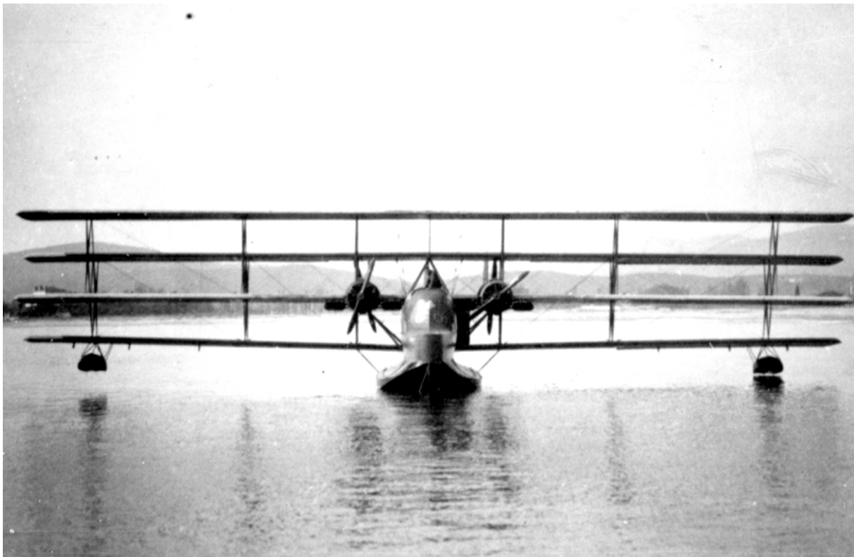
Cette vue de face montre la forme particulière de la coque, très amortie, traitée de façon indépendante, sur laquelle était posée le fuselage. (Photo Jacques Moulin)
