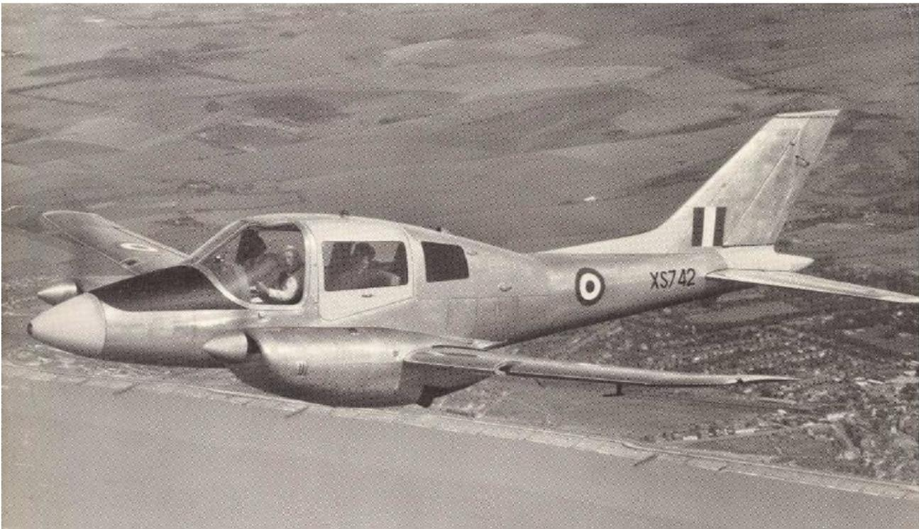
[Survolant la côte sud de la Grande Bretagne le premier de deux appareils de présérie B.206Z. Les capots-moteurs ont été modifiés et le fuselage n'est pas encore peint, mettant en évidence les éléments en fibre de verre formant les pointes avant et arrière du fuselage \(Beagle Aircraft Ltd\)](#)
