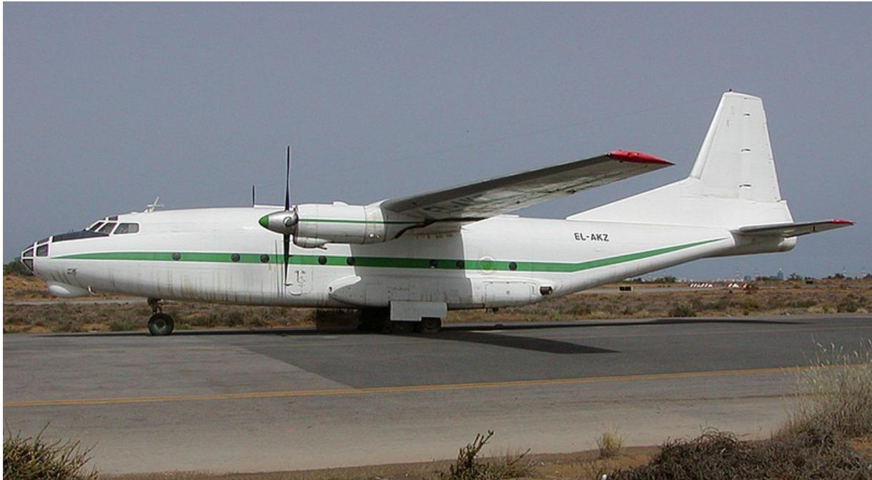
Passés sur le marché civil, les Antonov 8 furent équipés d'un APU identique à celui monté sur l'Antonov 12, monté à l'arrière du carénage longeant le train principal gauche, dans un logement prévu à l'origine pour recevoir des lance-leurres. La tourelle arrière était remplacée par un carénage.
