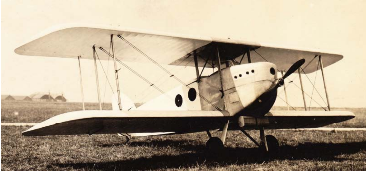
Cette vue du prototype Ni-D 380 permet de comprendre le mode de construction de l'appareil, réalisé autour d'un caisson central, plus sombre et comprenant deux sections centrales de voilure, le poste de pilotage et les mâts verticaux formant la cabane.
