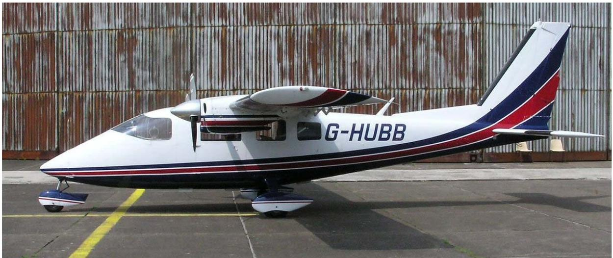
Les gouvernes sont simples à l'extrême. Ailerons Frise sans fente, volets à fente et rotation simple sur potences de 0° à 45°. Gouverne de profondeur monobloc, basse, à onglets de racine logeant les contremasses (23,7 % de la surface d'aile). Dérive à légère flèche.
