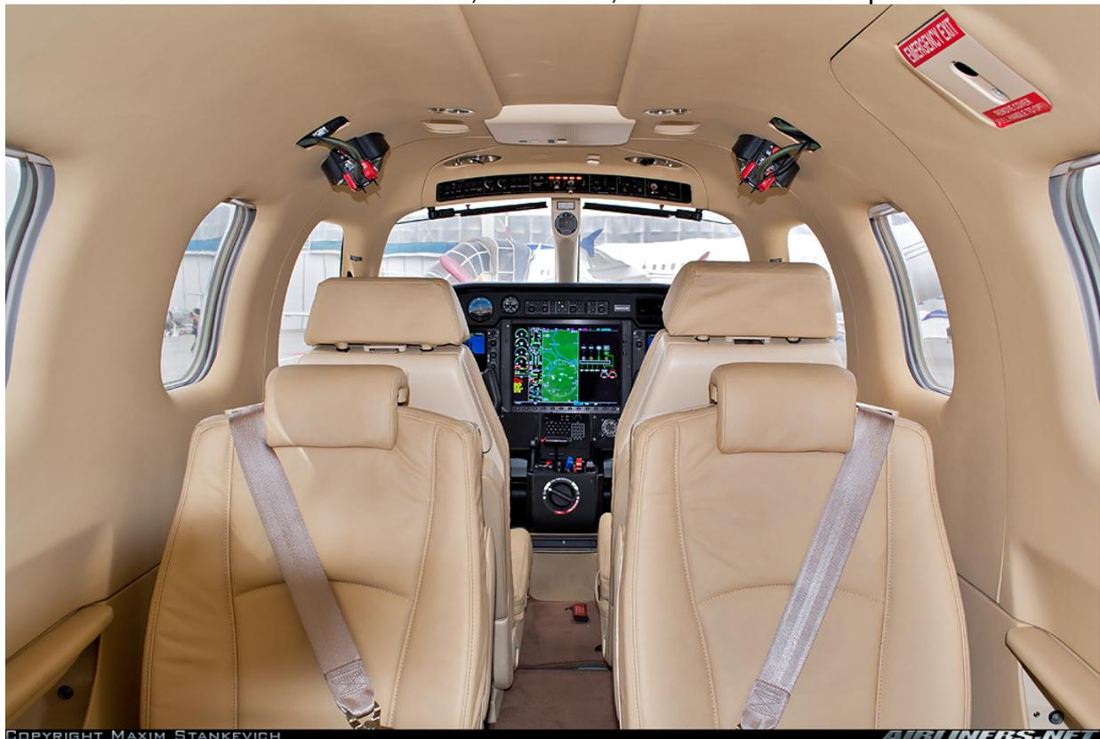
Les sièges allégés conçus par le bureau d'études de J.M. Klinka sont, sur option, recouverts de cuir et la table centrale escamotable ainsi que les garnitures, de la loupe de noyer, détail qui en dit long sur le degré d'élégance recherchée. Envol, le niveau sonore y est très faible, l'hélice tournant en croisière à faible vitesse (1800 RPM) à plus de 5 mètres devant.
