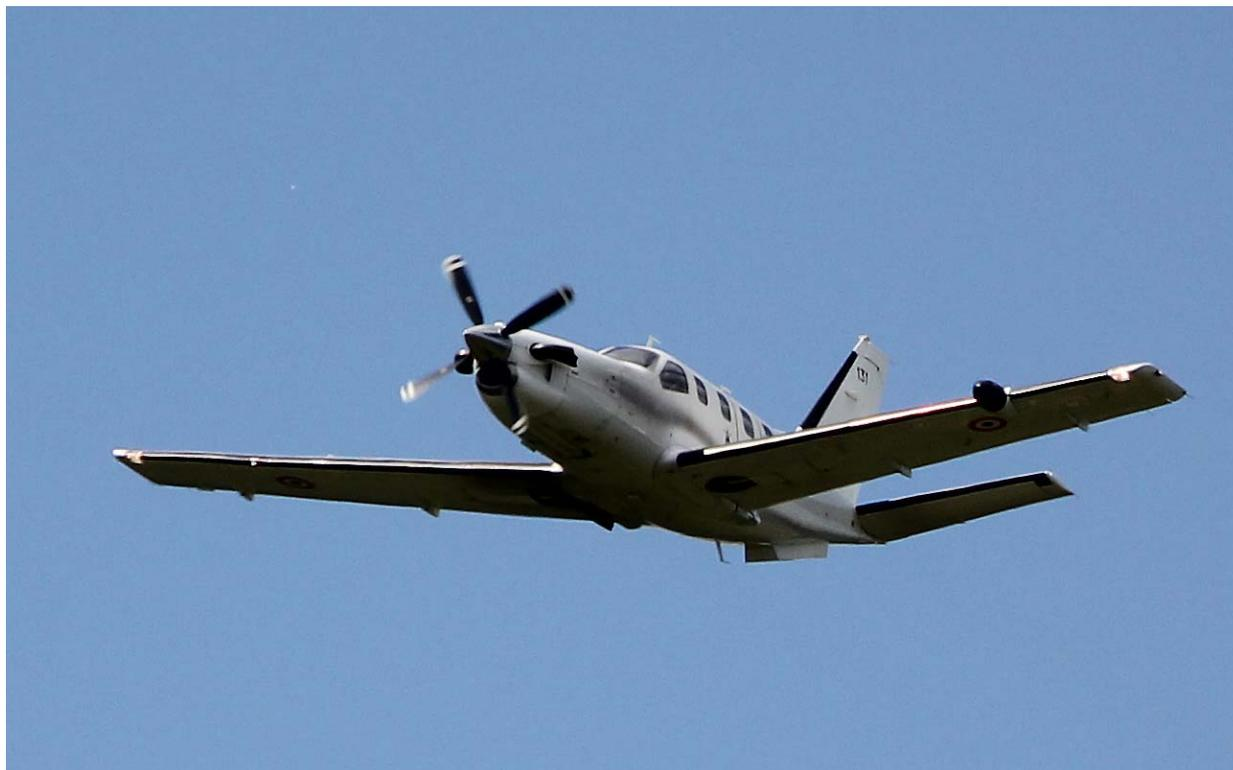
Dans les conditions optimum de confort avec, en léger bruit de fond, le souffle de la turbine, à une altitude cabine de 6500 pieds, il n'y a plus qu'à anticiper le déroulement du vol, le pilote automatique se chargeant du reste. L'équilibrage latéral est régulé automatiquement par un système transférant l'alimentation en kérosène alternativement d'un réservoir d'aile à l'autre toutes les dix minutes (et toutes les minutes au sol).
