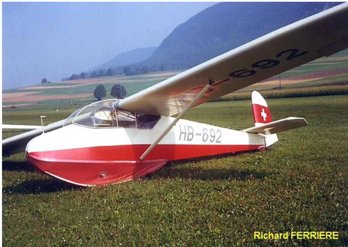
Pour l'atterrissage, la VOA sans vent est de 70 km/h. La poignée des aéro-freins sur le flanc gauche est basse et se trouve sous mon genou... ce sont des type DFS d'extrados avec une efficacité médiocre. La finesse passe bien à 8,5 lorsqu'ils sont tout sorti, mais on est loin d'obtenir la pente qu'offre des planeurs modernes, et paradoxalement, il y a un risque de se retrouver long... heureusement, le Ka-4 glisse merveilleusement bien et pose très court.
