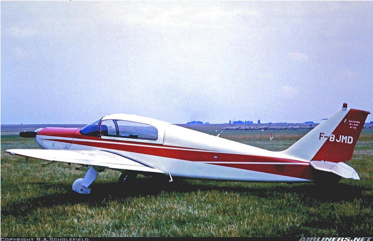
C'est un avion de ligne élégante reposant sur un large train classique escamotable en vol. Construit en bois, il est doté d'une verrière coulissante dont le plafond est en plastique capitonné. Le moteur est un Lycoming de 250 CV entraînant une hélice Hartzell à vitesse constante.
