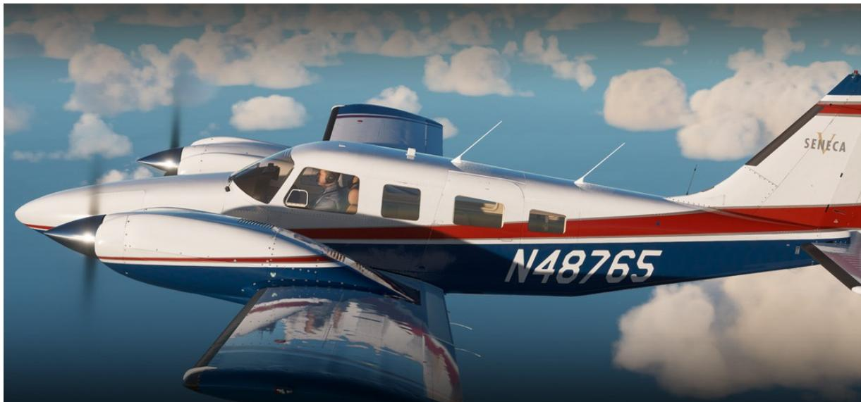
D'un point de vue confort, le niveau sonore en cabine est très acceptable, et il est relativement facile de régler les tours pour synchroniser les hélices et annuler le bruit généré par le différentiel de vitesse de rotation et de phase (le Seneca V est équipé d'un synchroscope qui effectue la correction automatiquement). Le « Fuel Flow » varie proportionnellement avec les changements de PA et il y a également peu de correction de richesse à effectuer.
