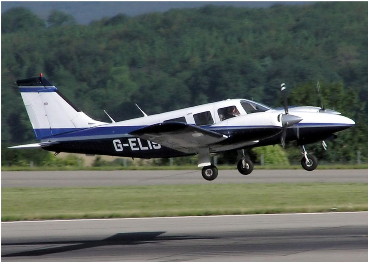
Avec les moteurs sur plein riche, plein petit pas et pompes électriques en marche, on s'aligne sur la piste et on augmente les gaz sur frein jusqu'à avoir 2000 RPM. Au lâché des freins, on applique progressivement la pleine PA (pression d'admission) et il n'est pas nécessaire de s'aider de la dissymétrie de puissance pour la tenue d'axe, qui est très aisée aux palonniers. La limite vent de travers démontrée est cependant assez faible avec 12 kt. A V1 = 90 mph, on effectue la rotation, et
