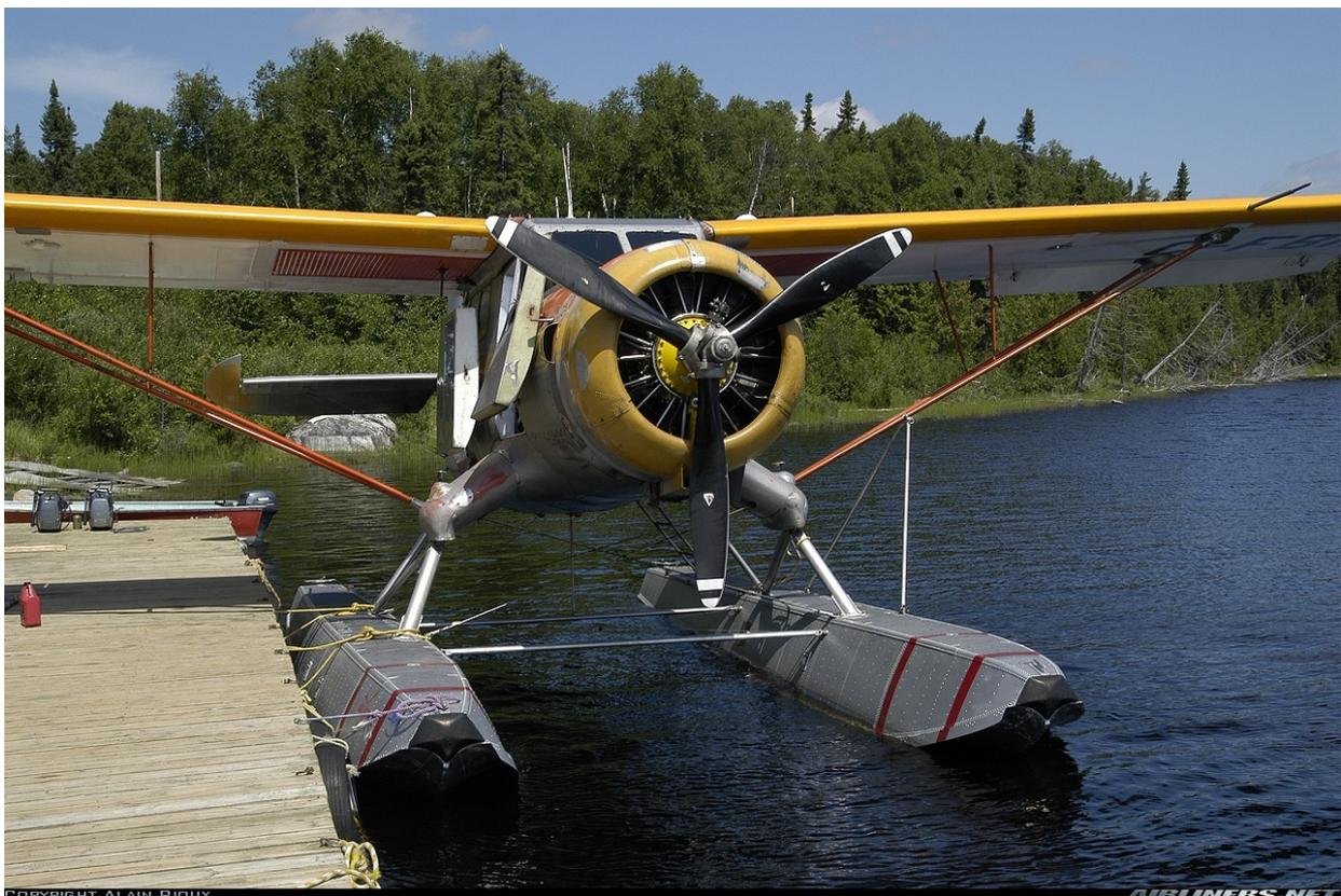
Le fuselage du Norseman, à structure en tubes d'acier soudés, fut prévu pour l'emport de charges encombrantes. La soute qu'il contient est donc volumineuse et capable de recevoir aussi bien des charges lourdes de petites dimensions que des paquets légers sous un volume important. Le constructeur a d'ailleurs prévu des portes pour les pilotes, afin de permettre l'accès du poste de pilotage sans nécessité de traverser une soute déjà remplie.
