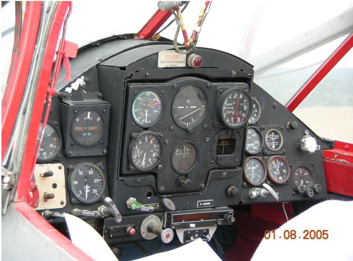
La console centrale, montée en relief par rapport au reste de la planche de bord, contient les instruments de vol et de navigation: badin (en km/h), alti (en mètres), vario (en m/s) avec indicateur d'assiette, compas, conservateur de cap, horizon artificiel et bille-aiguille.
