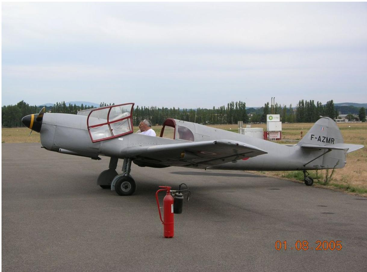
Avec une hauteur de 2 m, une longueur de 8,7 m et une envergure de 10,61 m, l'avion a des dimensions imposantes pour un avion léger (à titre comparatif, environ
