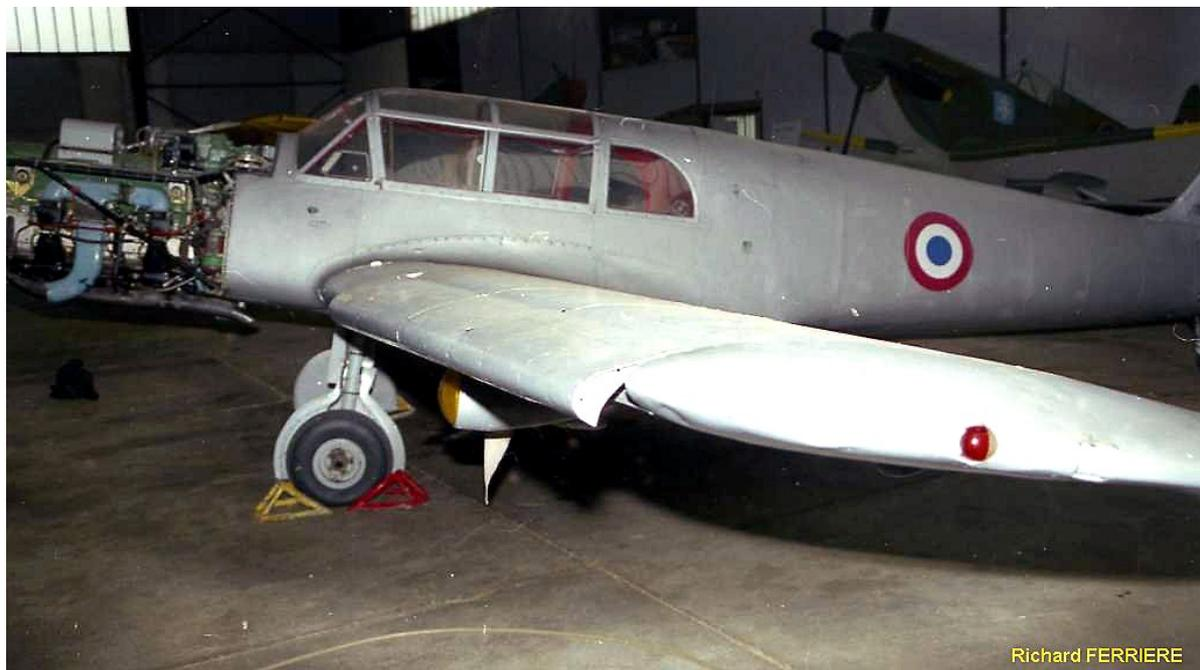
Aux bords de fuite, des volets à fente occupent les deux tiers de l'envergure à partir de l'emplanture et peuvent être baissés jusqu'à 50°; le dernier tiers est occupé par les ailerons. Il a été dit dans le chapitre sur l'historique de la machine que les Bf-108
