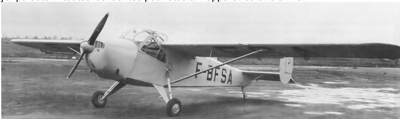
Sorti de son hangar, le NC-853 a un aspect bien particulier et un peu surprenant, écrasé sur son large train. Le moteur Minié en flat-four de 75 CV précède la cabine vitrée bien dégagée et transpercée par l'aile- médiane, supportée par des monomats raccordés à la partie supérieure des amortisseurs du train. Le fuselage entoilé est assez long et supporte, à son extrémité, un empennage à double dérive. L'immatriculation de l'appareil que j'ai sous les yeux est F.-BDZO.
