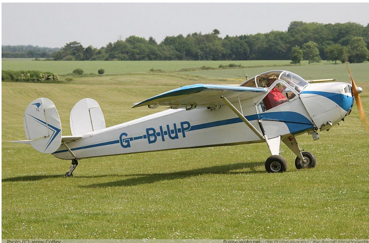
Avec un cran de volets, moteur réduit, l'avion montant à 6 m/s, c'est-à-dire fortement cabré, le décrochage se produit à 25 km/h. indiqué au badin et la perte d'altitude n'excède pas quelques mètres. Il y a peu d'avions capables d'une telle performance ! Mais il faut remarquer, toutefois, qu'à des vitesses aussi basses, les indications fournies par le badin ne peuvent être d'une absolue précision. Cette fois encore, aucune tendance, à une abattée latérale.
