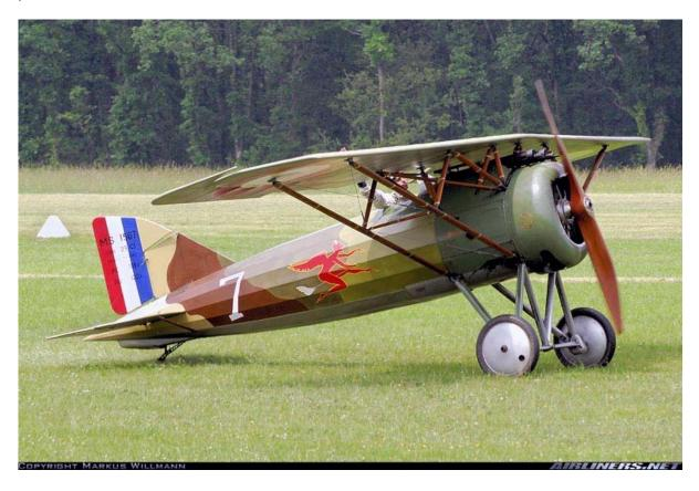
Le train d'atterrissage est métallique, mais par ailleurs très classique, pour l'époque, avec ses deux jambes de force de chaque côté, son faux essieu suspendu par sandows et ses grandes roues aux rayons entoilés. La béquille arrière est toute simple, en tôle épaisse avec patin soudé en bout et suspension à sandows là aussi.
