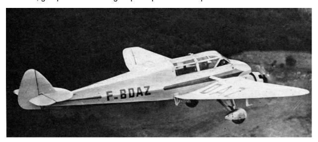
Avant d'entreprendre un vol, je passe la « revue de détail » de la machine. Son aspect extérieur est assez typique avec sa cabine bien dégagée et largement vitrée, ses ailes profondes et « cassées », puisque le tronçon compris entre la cabine et les
