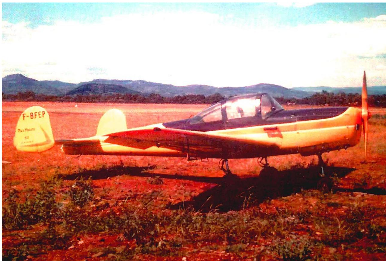
Conservant une vitesse de 110km/h je virai en montant et je remarquai une grande simplicité dans la conjugaison des commandes. Là, bille tient presque d'elle-même au milieu. Portant alors les yeux sur le variomètre, je constatai que je montais à 2 m/s. à 2200 t/min. Compte tenu de la vitesse de mon décollage, je me mis à un angle de cabré plus accusé, je montai à 3 m./s. au vario et 95 km/h au badin.
