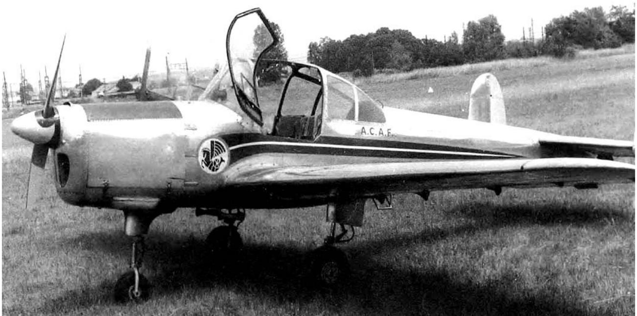
Seul à bord, volets rentrés, décrochage à 65km/h au badin à 400 m. plein réduit. Avec 2000 t/min, la vitesse est sensiblement la même. Avec les volets braqués à fond, soit 30°, le badin marquait moins de 50km/h, moteur réduit : avec le moteur à 2000 t/min. la perte de vitesse se produit aux environs de 55 km/h. Compte tenu de la vitesse de croisière, qui est de l'ordre de 190 km/h. à 2000-2050.t/min., il apparaît que l'écart de vitesse est très intéressant.
