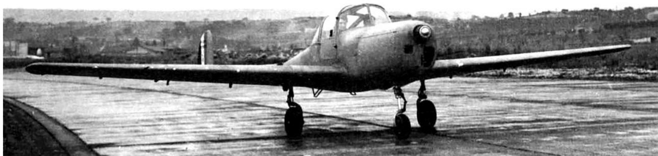
Les amortisseurs de l'appareil encaissent fort bien les cahots d'un terrain qui n'est pas magnifiquement nivelé. En bref l'évolution au sol est très agréable et on se sent tout de
