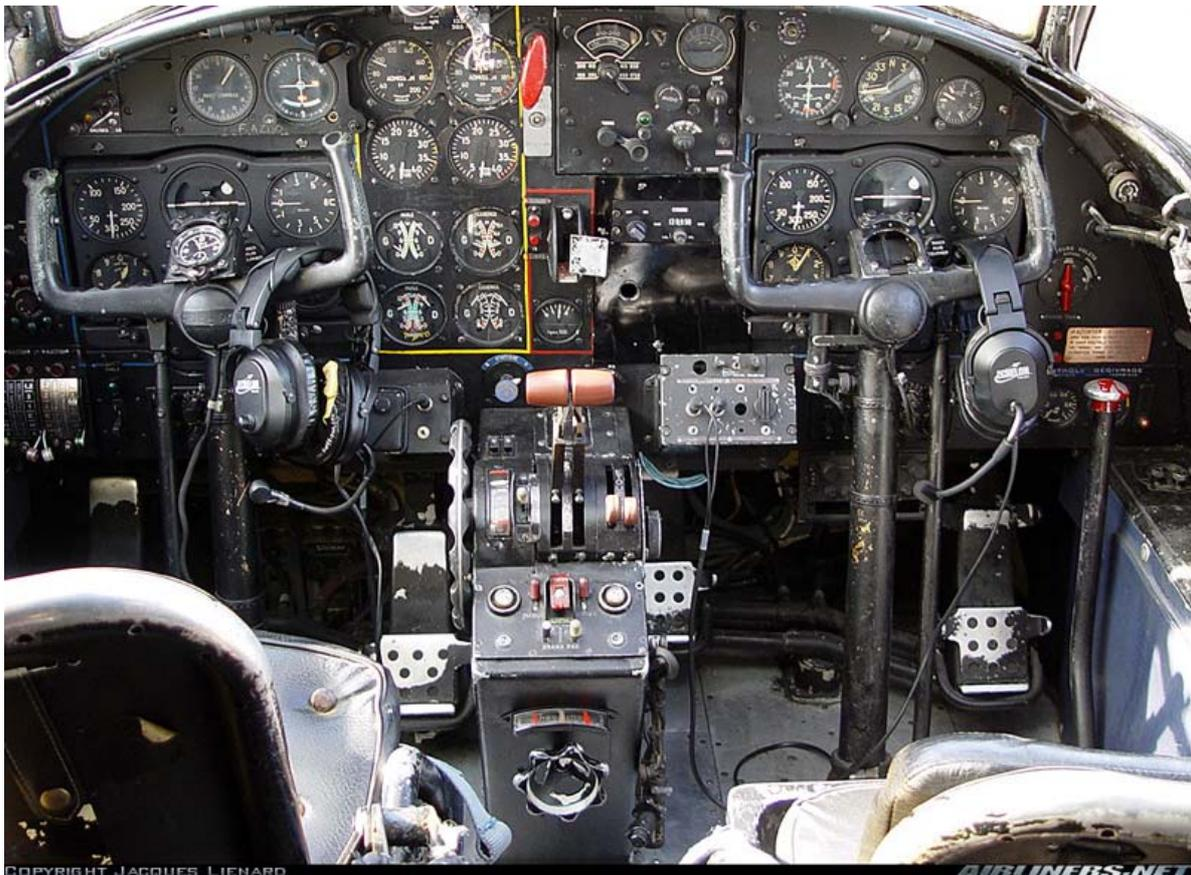
Sur le coté droit sur une planchette sont rassemblés un certain nombre de relais électriques et de radio, tandis qu'entre les deux pilotes sont réunies sur un bloc-pylône les commandes de gaz d'hélices et les flettners. Les sièges sont placés sur le plancher, qui est ici surélevé de la hauteur d'une marche ; ils coulissent sur des rails, permettant ainsi aux pilotes de se placer en bonne position par rapport au pa-
