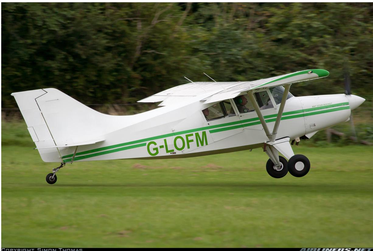
Vu la débauche de puissance sur un avion si léger, les 3000 pieds sont atteints en deux tours de trotteuse. La puissance alors ramenée à 23/33, régime qui correspond à 75% de la puissance, permet à la vitesse de se stabiliser à 140 mph. Cette vitesse peut être améliorée en passant les volets en portance négative, c'est-à-dire en les relevant de 7°,
