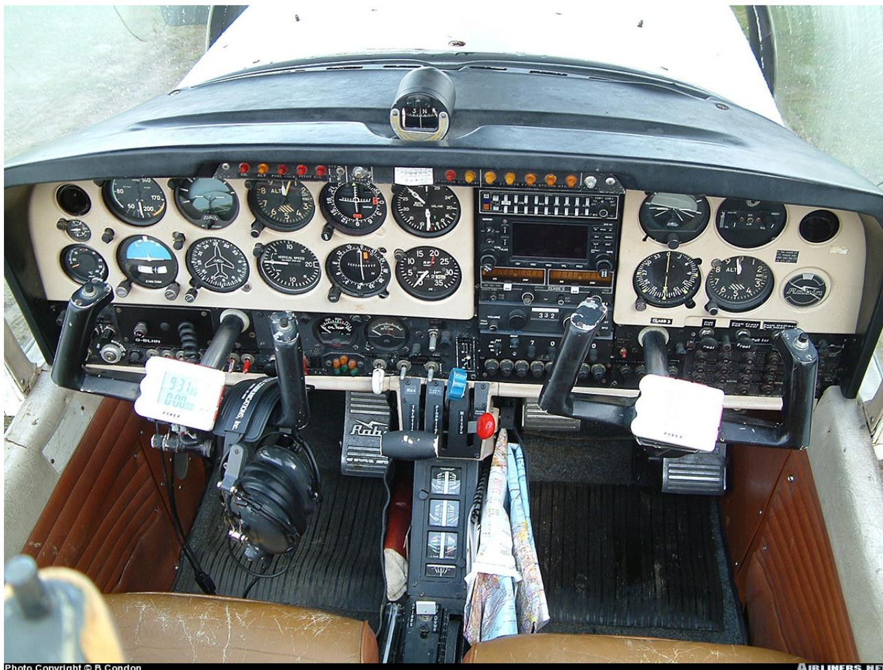
Ce tableau de bord est cependant très bien pourvu. En fait il est disposé pour permettre en optionnel l'équipement IFR du HR 100/200. Cette disposition est la suivante : de gauche à droite en haut ; anémomètre, horizon, altimètre n° 1 en pieds, répéteurs VOR-ILS. De gauche à droite, rangée médiane, chronomètre, indicateur de virage, directionnel, variomètre, altimètre n° 2,
