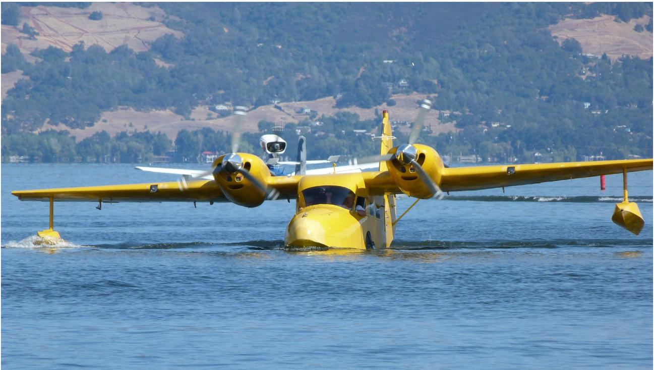
La sortie des volets s'accompagne d'un ralentissement net de la vitesse et du couple cabreur habituel, facile à contenir. La vitesse d'approche est de 104 mph (168 km/h). C'est trop ; mais, par sécurité, elle doit rester supérieure aux 90 mph de la VMC, au cas où un moteur couperait .
