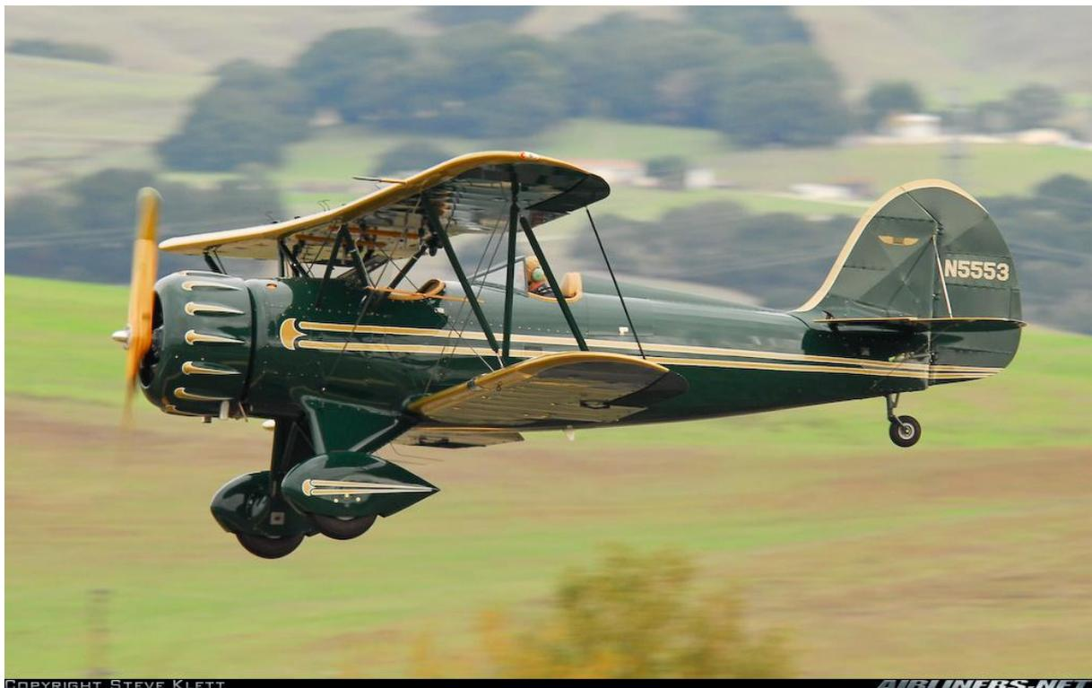
Le YMF est de dimensions légèrement plus réduites que son contemporain le Boeing Stearman : 9,14 contre 9,84 m d'envergure ; 7,26 contre 7,54m de longueur et 2,59 contre 2,95 m en hauteur. Pourtant, l'avion de chez WACO paraît plus imposant. Ceci est dû au niveau de finition élevé du YMF, conçu avec un fuselage plus volumineux, équipé de carénages autour du moteur et des roues, alors
