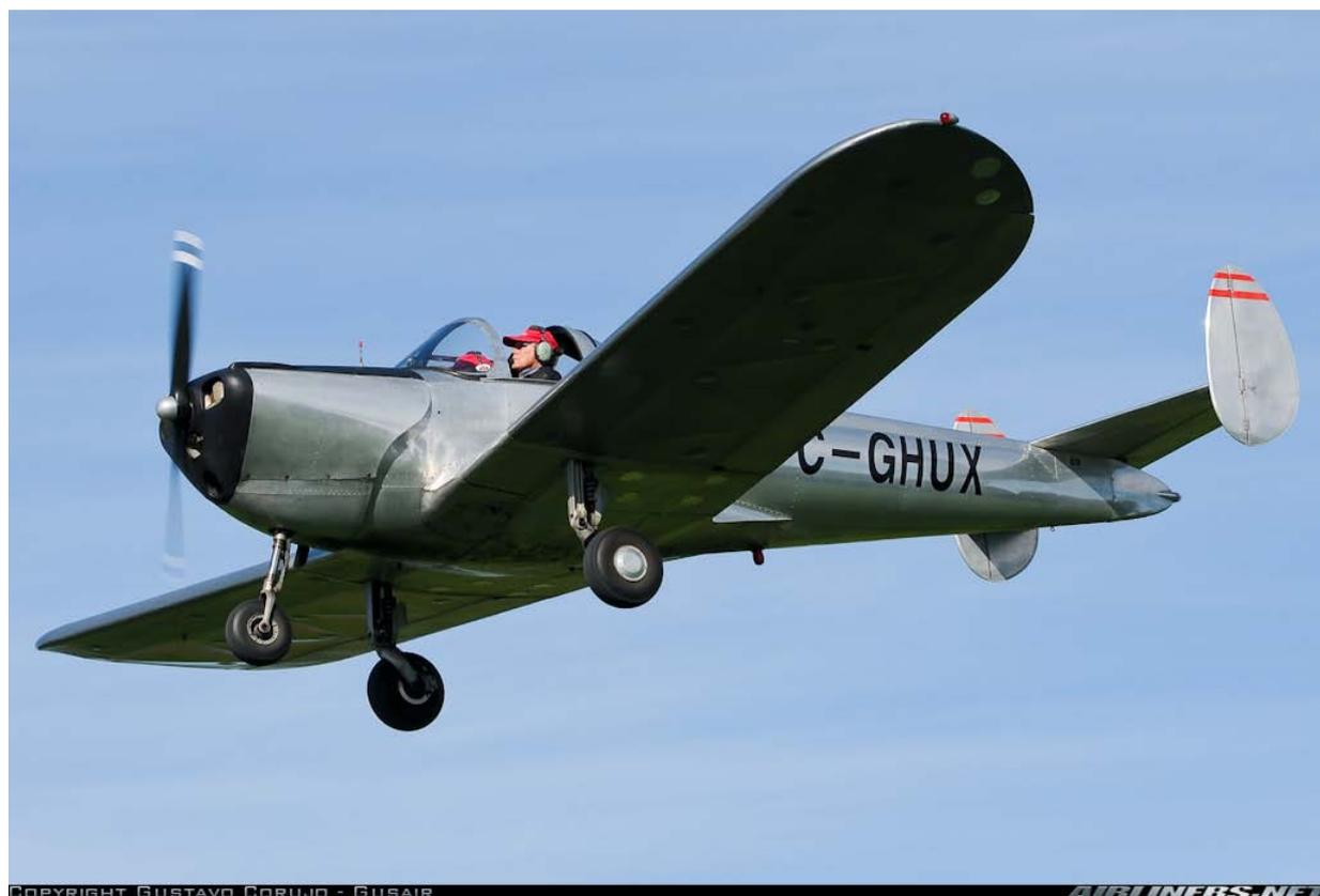
Avant l'atterrissage, la préparation de l'appareil en vent arrière se résume à la réchauffe carburateur. Il suffit ensuite de réduire les gaz, vers 2000 tours, et de laisser la vitesse se stabiliser entre 80 et 90 mph, soit entre 130 et 145 kilomètres-heure. En approche finale, la vitesse de 70 mph, soit 113 km/h, sera conservée jusqu'à l'arrondi.
