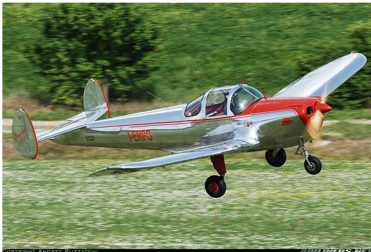
Le contrôle de la direction pourra être repris au volant une fois la décélération initiée. Il faut savoir en effet que la conception des commandes et la résistance des trains principaux aux efforts latéraux permettent un ripage important dans cette configuration d'atterrissage.
