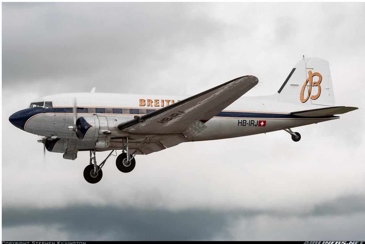
En vent arrière, le train sorti et les volets 1/4, on réajuste l'admission à 26. Vitesse stabilisée à 110 mph en base, on sort les volets à 2/4. La finale normale s'effectue volets 4/4 à 90 mph sans vent, hélices à 2250 t/min, admission de 20 pouces. L'arrondi effectué, on réduit progressivement les gaz.
