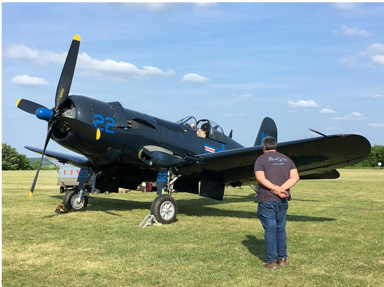
C'est donc le mécanicien qui fait la visite pré-vol. Le pilote fait encore un tour de l'avion avec lui, mais c'est surtout, en fait, pour se remettre dans le bain quand il ne vole é bord que quelques heures par an, et pour l'aider à brasser l'hélice avant la mise en route, afin d'évacuer l'huile des cylindres du bas. Par sécurité, nous comptons 16 pales.
