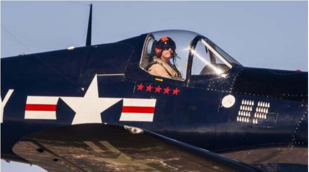
Les ailerons sont très doux, et la profondeur un peu plus lourde. L'augmentation de l'effort avec la vitesse est faible, et n'impose pas de compenser. Seule la direction durcit vraiment avec la vitesse. Si les compensateurs ont été convenablement réglés à 200 nœuds, il n'est plus nécessaire d'y toucher pendant toute la présentation, entre 100 (180) et 360 nœuds (580 km/h). A cette vitesse les commandes deviennent fermes, mais sans plus, et les débattements sont faibles.
