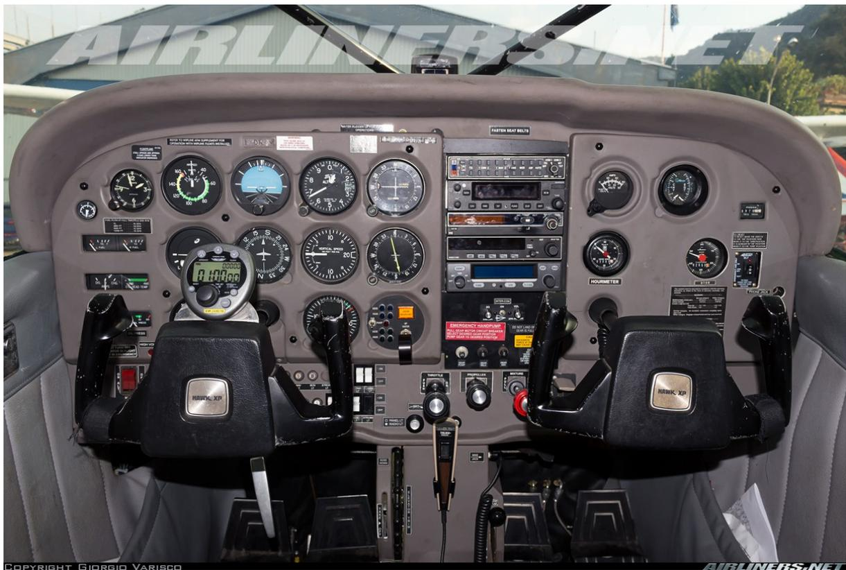
On trouve également sur la console centrale, en plus de la traditionnelle roue de trim de tangage, un compensateur de direction et un volet de capot pour gérer respectivement le couple et la température des cylindres du gros IO-360. En s'installant, on remarque immédiatement les 2 barres de renfort en V qui relient le milieu de la casquette du tableau de bord aux emplantures des ailes. Même si elles traversent les pare-brises en diagonales, elles ne gênent pas vraiment la visibilité et
