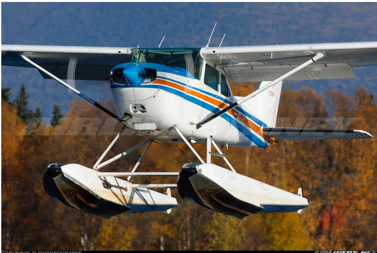
On repousse alors très légèrement le volant vers l'avant et l'appareil décolle vers 60 kt ; montée initiale à 70 kt. Avec des valeurs de température de pression de 10°C et 1013 hPa respectivement, le vario affiche immédiatement un surprenant 1000 ft/min, proche des 1150 ft/min maximum donnés par le constructeur pour le R172K à roues de 210 ch. Pleine puissance et plein petit pas, les instruments moteurs indiquent 25
