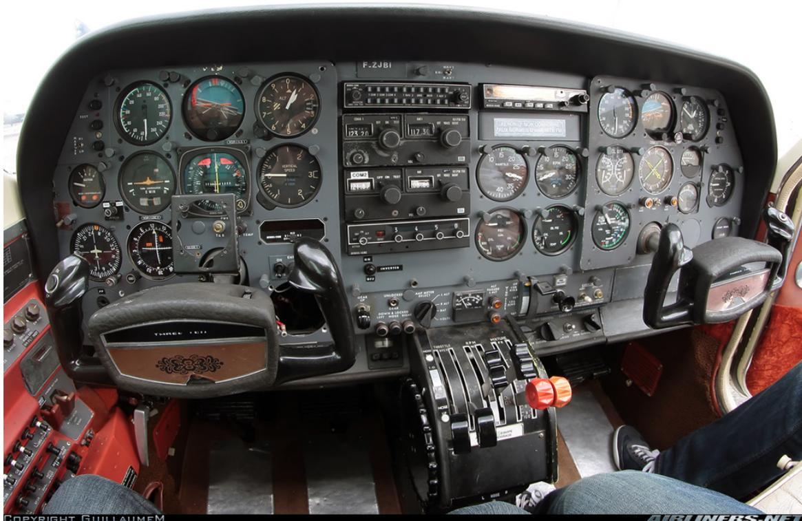
Son tableau de bord est très complet. Il trouve les instruments de navigation devant lui, avec la planche VSV, bien entendu. Au centre, l'équipement radio. A droite, devant le copilote les instruments moteur. Ce dernier panneau, quoique un peu loin du pilote est lisible de sa place.
