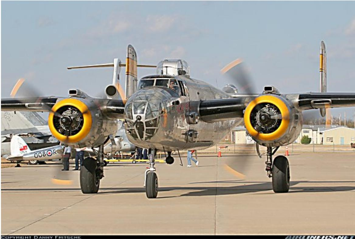
La mise en route des moteurs Wright de 1700 chevaux est aussi facile que sur un petit avion. On fait des injections, on lance le volant inertiel du démarreur pendant une bonne dizaine de secondes avant de l'embrayer, puis de brancher les magnétos. Le démarrage est alors quasi-immédiat. Même chose pour le moteur numéro 2, et on est prêt à rouler après avoir contrôlé les pressions d'huile, le fonctionnement du circuit hydraulique et les températures.
