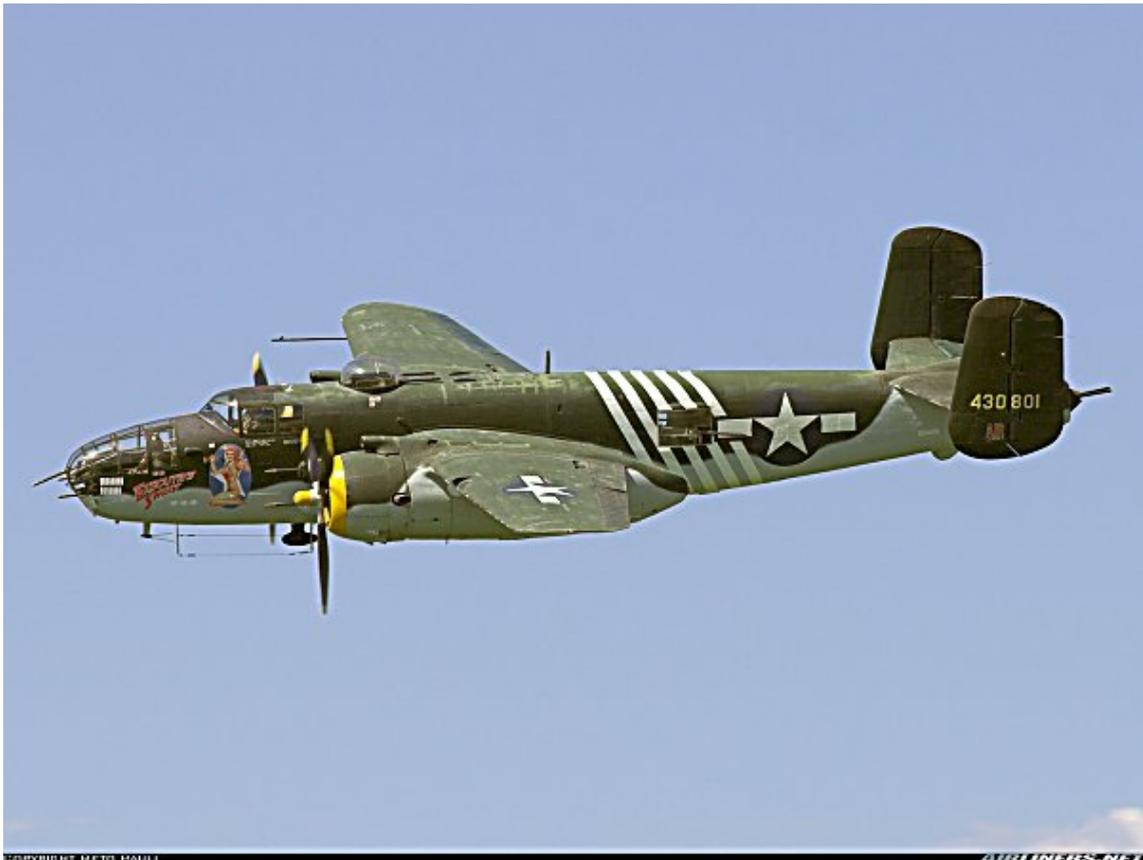
Une diminution de pente nous amène à la  $V_{mc}$ , vitesse à laquelle le contrôle reste excellent. Il est vrai que les traînées sont rentrées, et que la pression d'admission du moteur en service n'est que de 36 pouces. Après avoir effectué une simulation de panne de l'un, puis de l'autre moteur, je ne pourrais pas affirmer que la différence de comportement soit bien marquée; mais cela est normal, compte tenu des conditions de l'essai.
